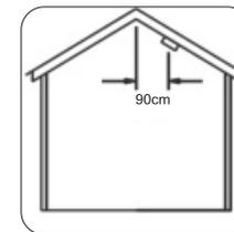
Czujnik dymu należy instalować w odległości 90 cm od szczytu sufitu (patrz rysunek).
