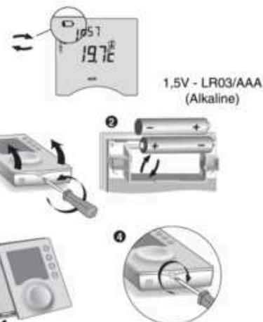
Pokud jsou baterie vytaženy déle než 30 s., resetuje se nastavení data a času. Pokud se tak stane, znova je nastavte.
